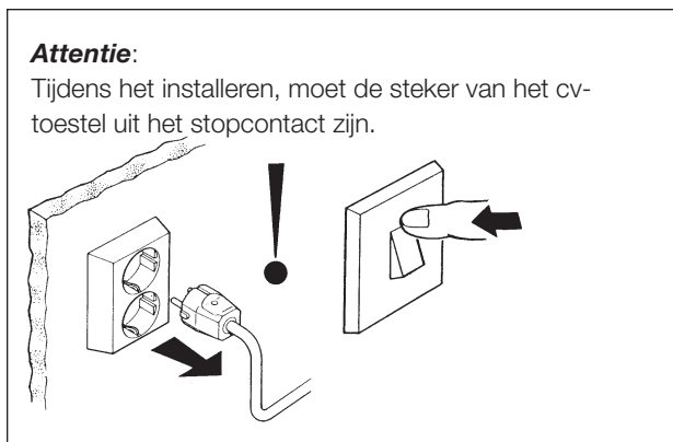
Figuur 2: cv-toestel spanningsloos maken
