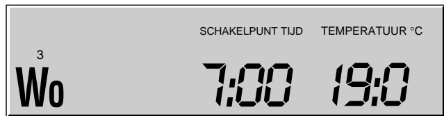
figuur 10: Een willekeurig schakelpunt op het display
