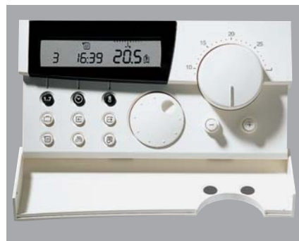
ModuLine 30 met open frontklepje Handig toets-en-draaisysteem: met de toetsen bepaalt u wat u gaat instellen (bijv. de dag van de week), vervolgens draait u aan de programmaknop tot de juiste dag op het display staat.
